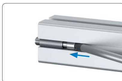
Schraube mit Schraubendreher durch die Hülse drücken
