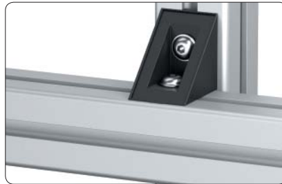
Abstützung quer zum Profil Bei dieser Anwendung muss die Drehsicherung an einem Schenkel entfernt werden.
